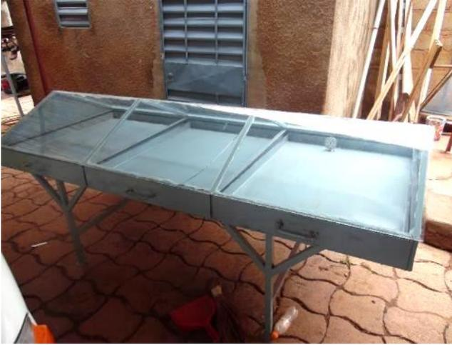
Prototyp eines Solartrockners
